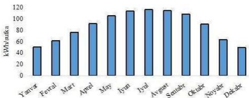
1-rasm. 15 kW quvvatli quyosh panellarini ishlab chiqargan elektr energiyasi ko'rsatgichlar
